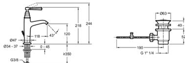
Descriptif CCTP : Mitigeur lavabo avec vidage. E24307. Collection : CLÉO 1889. DIMENSIONS : 15,50 x 4,70 cm. POIDS : 1,3 kg. MATÉRIAU : Métal. TYPE D'INSTALLATION : 1 trou. TYPE : Mitigeur. DÉBIT (L/MN SOUS 3 BAR) : 5 l/mn. HAUTEUR TOTALE DU ROBINET (MM) : 218. SAILLIE DU BEC (MM) : 118. RACCORDS : Avec flexibles d'alimentation. MÉCANISME : Cartouche à disques céramique. VIDAGE : Avec. GARANTIE MÉCANISME : 5 ans. GARANTIE FINITION : Chrome 10 ans / PVD 25 ans. DURÉE GARANTIE (ANNÉES) : 5.
