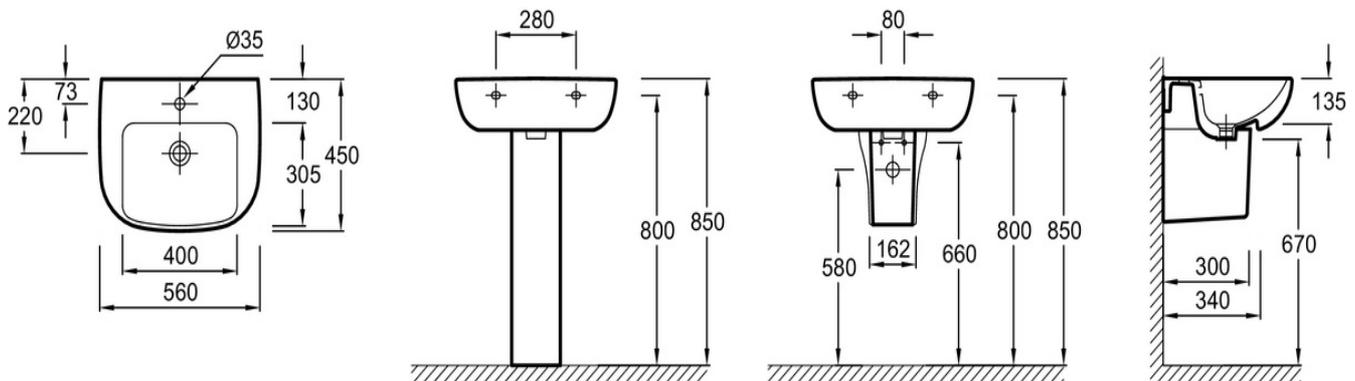
Descriptif CCTP : Lavabo 56 cm. E4737. Collection : ODÉON UP. DIMENSIONS : 56 x 43 cm. POIDS : 15,2 kg. MATÉRIAU : Céramique. TYPE D'INSTALLATION : Autoportant. NORMES ET RÉGLEMENTATIONS : NF ; FDES. CONFIGURATION : Standard. PERCEMENT ROBINETTERIE : 1 trou. TROP-PLEIN : Avec trou de trop-plein. ROBINETTERIE CONSEILLÉE : Aleo. DURÉE GARANTIE (ANNÉES) : 10. INFORMATIONS COMPLÉMENTAIRES : Robinetterie non incluse.
