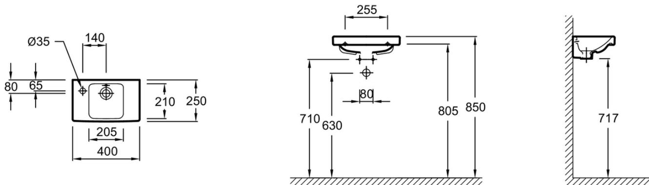
Descriptif CCTP : Lave-mains 40 cm, percé à gauche. E4759G. Collection : ODÉON UP. DIMENSIONS : 40 x 25 cm. POIDS : 5,5 kg. MATÉRIAU : Céramique. TYPE D'INSTALLATION : Autoportant. CONFIGURATION : Compact. PERCEMENT ROBINETTERIE : 1 trou. TROP-PLEIN : Avec trou de trop-plein. ROBINETTERIE CONSEILLÉE : Aleo. DURÉE GARANTIE (ANNÉES) : 10. INFORMATIONS COMPLÉMENTAIRES : Robinetterie non incluse.
