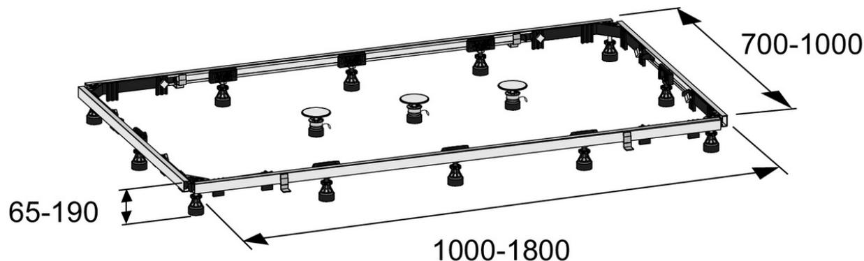
Descriptif CCTP : Cadre acier de rehausse 100 x 180 cm. E61427. Collection : Hors collection. DIMENSIONS : 100 x 180 cm. MATÉRIAU : N/A. TYPE D'INSTALLATION : Posé. TYPE D'ACCESSOIRE : Kit de rehausse. DESCRIPTION KIT DE RÉHAUSSE : Cadre de rehausse pour receveurs de 100 x 180 cm maxi. ANTIDÉRAPANT : Non. DURÉE GARANTIE (ANNÉES) : 2.
