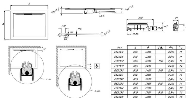
Descriptif CCTP : Receveur 120 x 90 cm. E62327. Collection : FLIGHT PURE. DIMENSIONS : 120 x 90 x 2,60 cm. POIDS : 32 kg. MATÉRIAU : Flight. TYPED'INSTALLATION : Surélevé, posé ou encastré. NORMES ET RÉGLEMENTATIONS : CE. ANTIDÉRAPANT : Non. FORME : Rectangulaire. MOTIF DE SURFACE : Lisse. NIVEAU D'ADHÉRENCE : PN6 selon norme NF. LIVRÉ AVEC BONDE : Oui. KIT DE RÉHAUSSE EN OPTION : Oui. DURÉE GARANTIE (ANNÉES) : 10. En option : Kit de réhausse (hauteur +10/13 cm).
