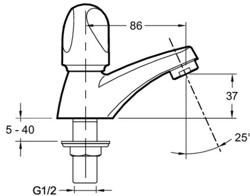
Descriptif CCTP : Robinet indépendant (eau chaude). E72923. Collection : GALÉO CD. MATÉRIAU : N/A. TYPE D'INSTALLATION : 1 trou. NORMES ET RÉGLEMENTATIONS : NF : II - EAU : E1 A1 U3 - ACS : 15ACCLY265. DÉBIT (L/MN SOUS 3 BAR) : 10 l/mn. SAILLIE DU BEC (MM) : 86. MÉCANISME : Têtes à disques céramique. VIDAGE : Sans. DURÉE GARANTIE (ANNÉES) : 5. Poignée eau chaude. Sans bonde de vidage.
