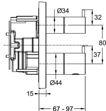
Descriptif CCTP : Mitigeur thermostatique à encastrer, 2 sorties. E78024-4A. Collection : MÉTRO. MATÉRIAU : Métal. TYPE D'INSTALLATION : Encastré. DÉBIT (L/MN SOUS 3 BARS) : 26 l/min. TYPE : Mitigeur. MITIGEUR : Thermostatique. BUTÉE DE SÉCURITÉ : 38°C. TEMPÉRATURE MAXI : 50°C. CLAPET ANTI-RETOUR : Oui.
