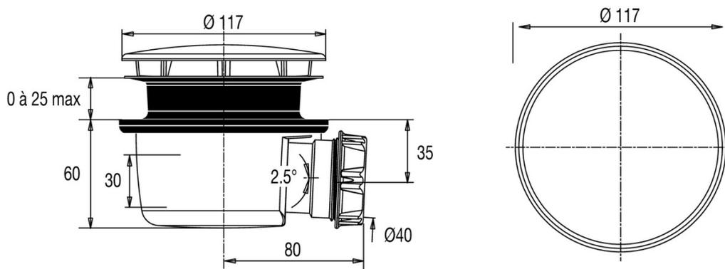
Descriptif CCTP : Bonde extra-plate NF avec capot. E78171. Collection : Hors collection. DIMENSIONS : 14 x 9 x 6 cm. POIDS : 0,3 kg. MATÉRIAU : N/A. TYPE D'INSTALLATION : Posé. TYPE D'ACCESSOIRE : Bonde. ANTIDÉRAPANT : Non. DIAMÈTRE DE BONDE (CM) : 9. DURÉE GARANTIE (ANNÉES) : 2. Débit 28 l/mn. Sortie : 40 mm à visser ou à coller.
