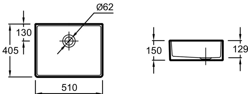
Descriptif CCTP : Timbre à poser 51 cm, ESA01. Collection : DELTA. DIMENSIONS : 51 x 40,50 cm. POIDS : 13 kg. MATÉRIAU : Céramique. TYPE D'INSTALLATION : Posé. NORMES ET RÉGLEMENTATIONS : NF. PERCEMENT ROBINETTERIE : Sans trou. TROP-PLEIN : Sans trou de trop-plein. DURÉE GARANTIE (ANNÉES) : 10.
